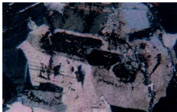
Рис. 3. Гранит. Темно-бурый битумоид в порах выщелачивания в плагиоклазе. Увел. × 40 Николы + Глуб 4307 м., скв. БТ 448.
