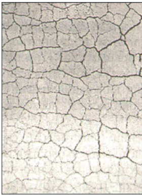
Рис. 1. Образование блоковой структуры в условиях двухосного растяжения (Ревуженко, 2000)
