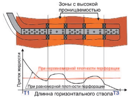
Рис. 9. Влияние распределения плотности перфорации на распределение притока к стволу горизонтальной скважины.
