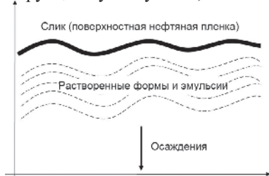
Рис. 1. Вертикальный разрез нефтяного загрязнения водной среды.
