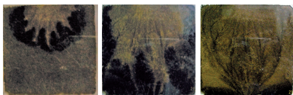
Рис. 5. Визуальное изменение порового пространства модели в процессе извлечения СВН (Ашальчинское месторождение) при 10% содержании.
