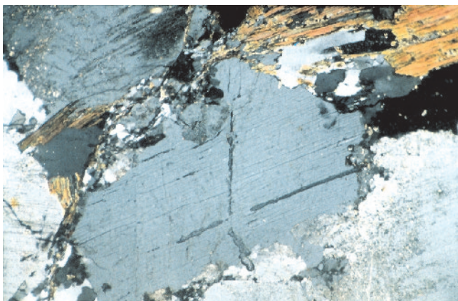
Рис. 6. Биотит-плагиоклазовый гнейс. Удлиненные полости газовой-жидких включений по плоскостям спайности и по деформационным трещинкам, пересекающим плоскости спайности в ортоклазе. Скв. 678, Тлянчи-Тамак, гл. 2392, 0м. Николи +. Ув. 125х.
