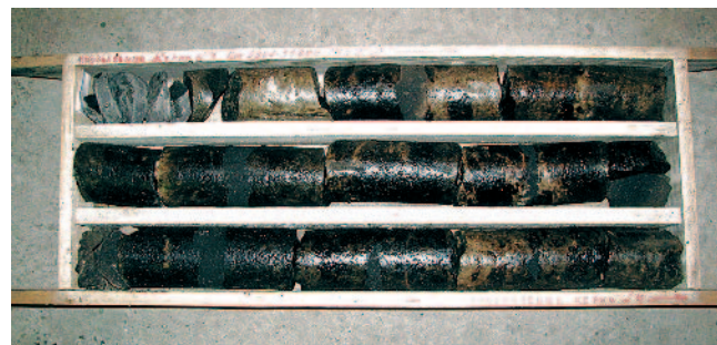
Рис. 4. Запарафинированный керн, отобранный из скважины, 100%-ый вынос керна.
