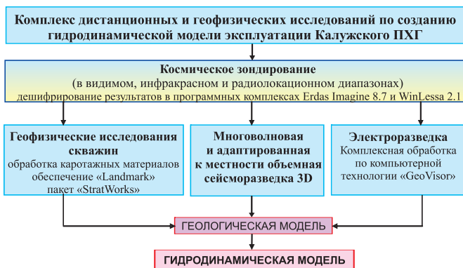
Рис. 2. Схема комплекса исследований по созданию современной технологической модели Калужского ПХГ.
