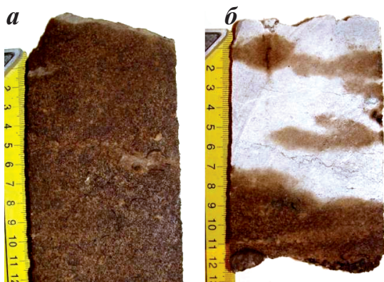
Рис. 1. Различные виды нефтенасыщенности керна. Тавельское месторождение. а) Равномерно нефтенасыщенный образец керна. Скв. 5035. Гл. 761,9 м. б) Неравномерно нефтенасыщенный образец керна. Преобладают плотные участки (белое). Скв. 5035. Гл. 762,9 м.
