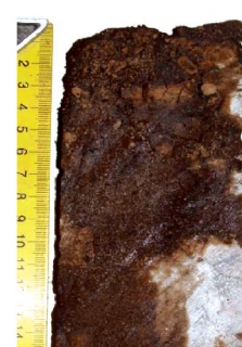
Рис. 3. Трещинки растворения. Тавельское месторождение. а) Трещинки растворения, видимые под микроскопом в шифре. Обр. 2. Скв. 5035. Один николь. б) николи скрещены. в) Вертикальная трещинка растворения на границе плотных и нефтенасыщенных известняков. Нефтяная залежь. Скв. 5051. г) Сетка вертикальных и горизонтальных трещинок растворения. Зона ВНК. Скв. 5053. Гл. 1065,2 м.
