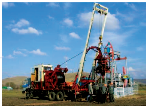
Рис. 3. Обработка ПЗП кислотным составом ИТПС-РС марки «А». Недостатки НСІ 15 МЛ, НСІ 24МЛ: длительное реагирование кислоты, высокая скорость реакции. Преимущества ИТПС-РС марки «А»: кислота замедленного действия, длительный срок эффекта от обработки, высокая успешность.
