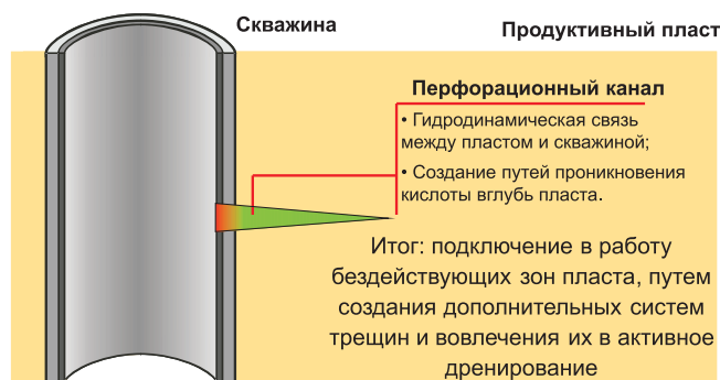
Рис. 6. Схема перфорационного воздействия на пласт при наличии обсадной колонны в скважине.
