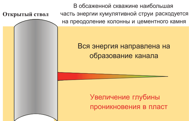
Рис. 7. Схема перфорационного воздействия на пласт при отсутствии обсадной колонны.
