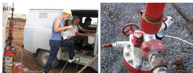
Рис. 3. Исследования ВАЦ на скважине: а) передача отраженного акустического сигнала на цементометр, размещенный в салоне автомобиля; б) установка датчиков приемника и излучателя на колонне.
