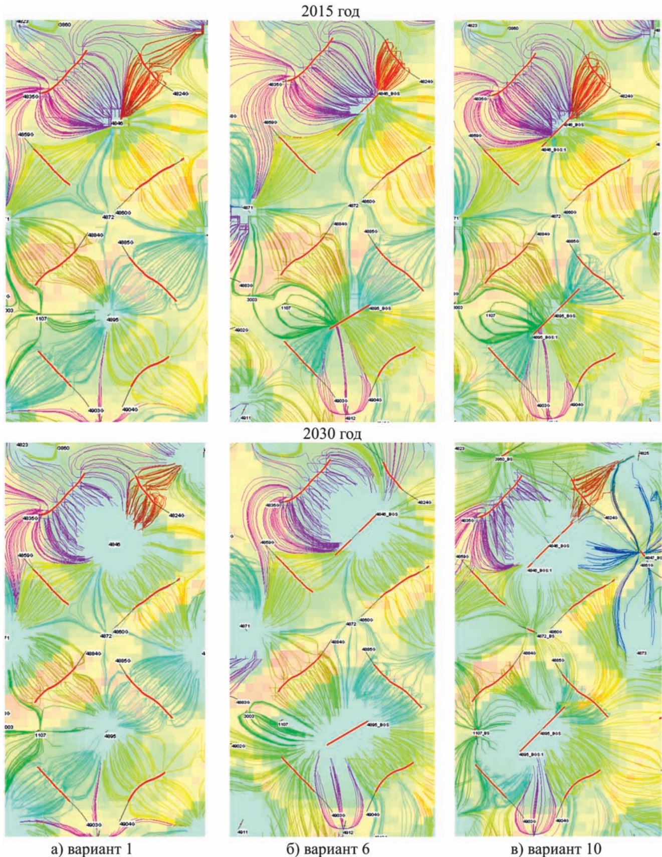
Рис. 12. Фильтрационные линии тока нефти к добывающим скважинам по вариантам.
