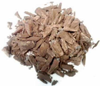
Рис. 8. Характер разрушения образца с 5% отхода магнезита. T_{обж.} = 1150^{\circ}C . Прочность при сжатии 148 МПа.
