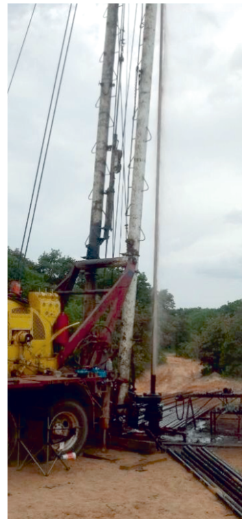
Рис. 2. Фотография фонтана смеси (вода – 70%, нефть – 30%) из скважины № 8.
