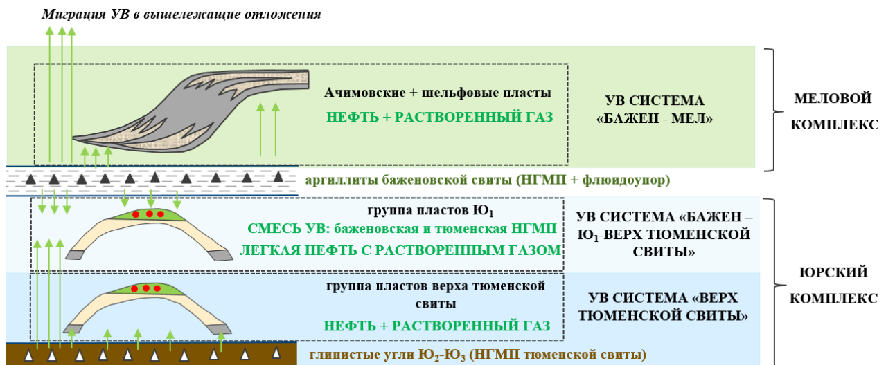
Рис. 15. Генерализованная схема строения углеводородных систем в периметре работ
