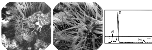
Рис. 6. Слева направо: волосовидные кристаллы железо-алюминиевых квасцов в породах БС, ув. 300 \times . Фрагмент предыдущего снимка, ув. 1000 \times . Энерго-дисперсионный спектр кристаллов железо-алюминиевых квасцов: Al, S, Fe
