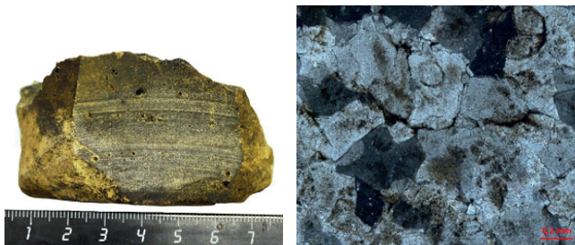
Рис. 4. Вторичный доломит нефтенасыщенный с неконформной структурой. Березовская площадь. Скв. 25276. Гл. 1681,25 м. Слева фотография образца, справа его шилфа (один николь).
