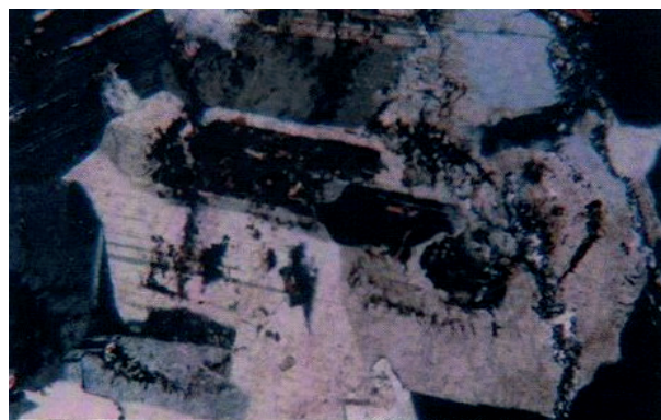
Рис. 3. Гранит. Темно-бурый битумоид в порах выщелачивания в плагиоклазе. Увел. × 40 Николи + Глуб 4307 м., скв. БТ 448.
