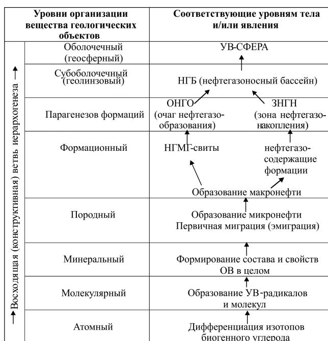
Рис. 1. Иерархический принцип онтогенеза углеводородов и их скоплений
