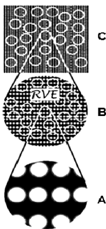
Рис. 1. Иерархия масштабов гетерогенной среды: А – микромасштаб, В – мезомасштаб, С – макромасштаб (Bear, 1972)
