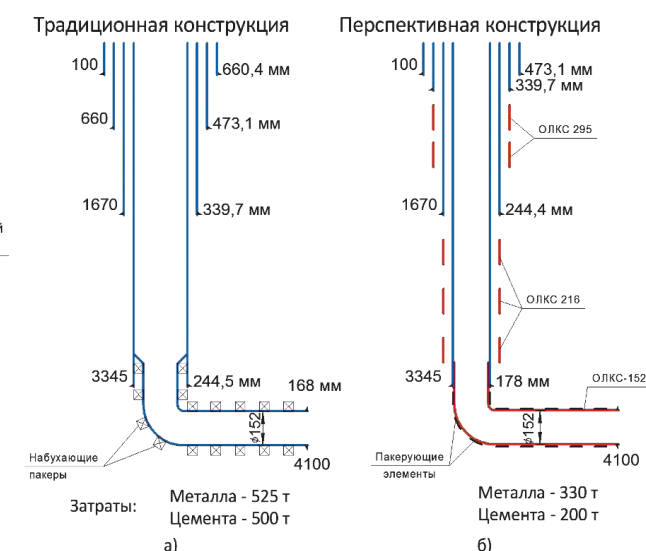
Рис. 9. Примеры конструкций морских скважин: Традиционная конструкция – строительство скважин с ликвидацией осложнений закачкой в скважину тампонажных материалов; Перспективная конструкция – строительство скважин с применением расширяемых труб
