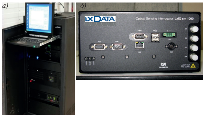
Рис. 9. Аппаратная стойка центра управления (а) и контрольная панель (б) размером 19" ( www.weatherford.com )
