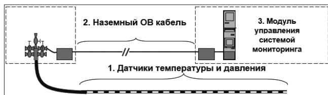
Рис. 5. Схема компоновки внутрискважинных датчиков и наземной части системы мониторинга
