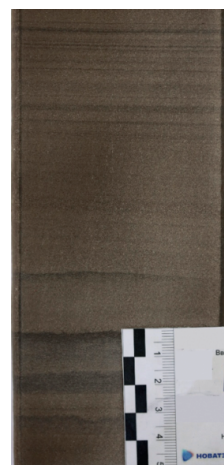
Рис. 5. Отложения приливо-отливного бара (tidal bar). Песчаник светло-серый мелкозернистый с субгоризонтальной, в нижней части пологоволнистой слоистостью, которая обусловлена намывами СУМ (слюдисто-углистый материал) и СУГМ (слюдисто-углисто-глинистый материал)
