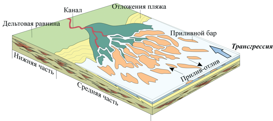
Рис. 7. Концептуальная блок схема для прибрежно-континентальных и дельтовых отложений для нижней и средней части пласта Ю 2 1
