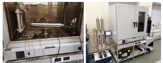
Рис. 12. Фильтрационная установка для проведения экспериментов по вытеснению нефти
