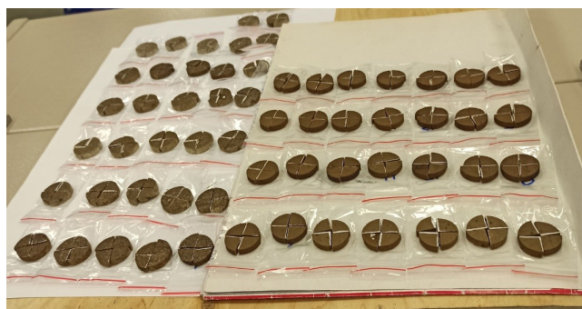
Рис. 8. Шляпки, распиленные на четвертинки, для проведения измерения КУС
