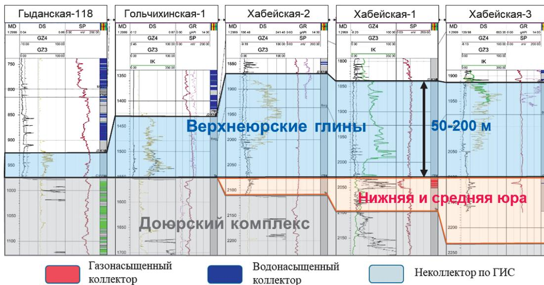
Рис. 5. Схема корреляции юрских отложений
