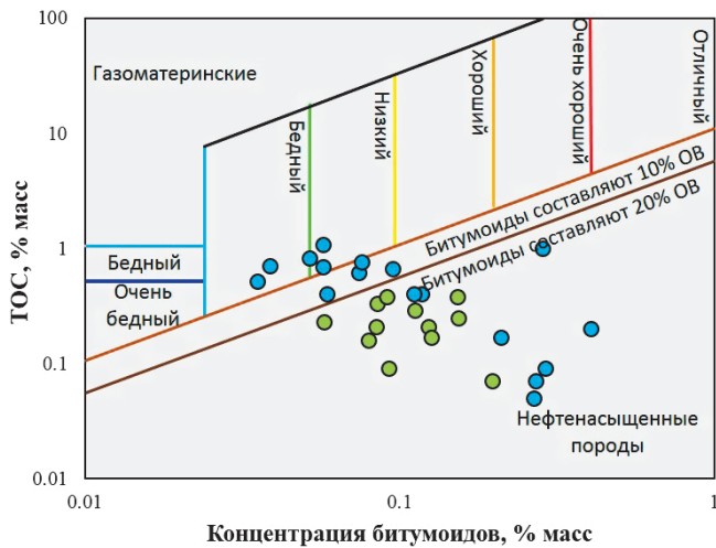
Рис. 3. Диаграмма зависимости концентрации битумоидов от концентрации органического углерода (ТОС) для среднеюрских (синие точки) и нижнемеловых (зеленые точки) отложений Восточно-Предкавказской НГО
