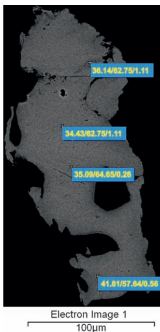
Рис. 4. Зерно золота с однородным распределением ртути (значения в процентах Ag/Au/Hg ).
