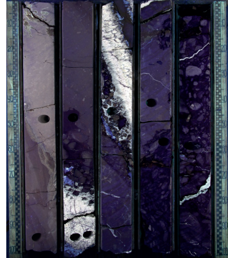
Рис. 5. Тектонические трещины (частично залечены кальцитом)
