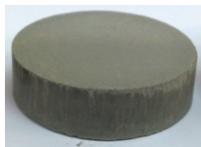
Рис. 1. Внешний вид спрессованного образца из бентонитового глинопорошка
