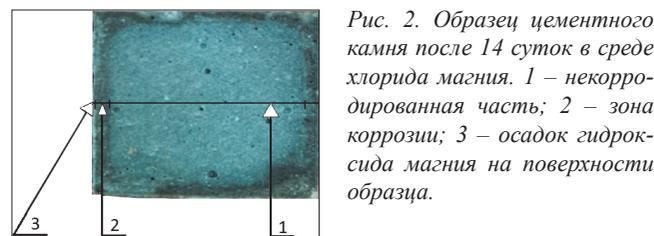
Рис. 2. Образец цементного камня после 14 суток в среде хлорида магния. 1 – некорродированная часть; 2 – зона коррозии; 3 – осадок гидроксида магния на поверхности образца.
