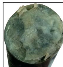
Рис. 8. Кристаллообразование хлорида магния на поверхности камня
