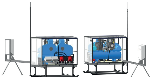
Рис. 2. Комплекс оборудования по отбору газа из скважин
