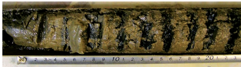
Рис. 2. Слоистость структуры донных отложений оз. Раифское.
