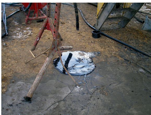
Рис. 1. Нефтепроявление в скв. № 4024 (11943) Екатеринбургского месторождения.
