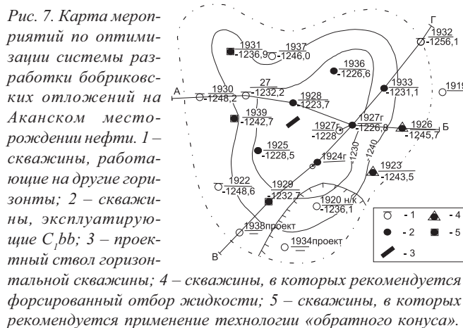
Рис. 7. Карта мероприятий по оптимизации системы разработки бобриковских отложений на Аканском месторождении нефти. 1 – скважины, работающие на другие горизонты; 2 – скважины, эксплуатирующие С 1 bb; 3 – проектный ствол горизонтальной скважины; 4 – скважины, в которых рекомендуется форсированный отбор жидкости; 5 – скважины, в которых рекомендуется применение технологии «обратного конуса».
