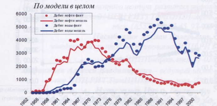
Рис. 3. Дебиты нефти и воды модельные и фактические по блоку 3 Павловской площади и по модели в целом.
