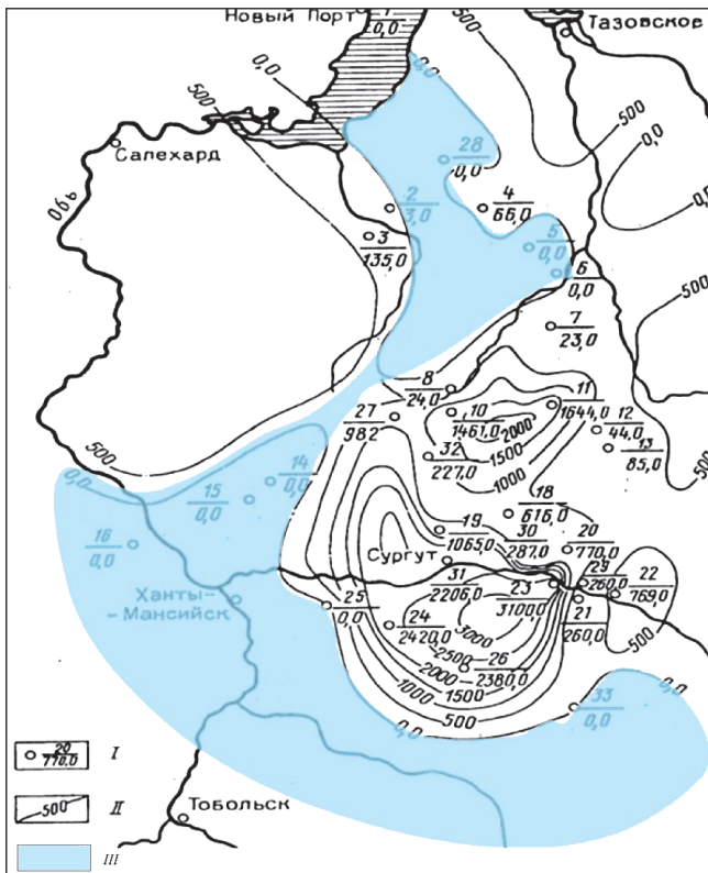
Рис. 1. Схема распределения содержания ванадиевых порфиринов (Vp) в ОВ пород баженовской свиты Западной Сибири (Чахмахчев, Пуанова, 1992; Пуанова, 2017). I – площади отбора керна (числитель) с указанием содержания Vp ( n \times 10^{-3}\% ) в ОВ (знаменатель). Площади отбора керна: 1 – Новопортовская, 2 – Надымская, 3 – Хейгинская, 4 – Ямсовейская, 5 – Губкинская, 6 – Тарасовская, 7 – Вэнгайхинская, 8 – Итурская, 9 – Коллективная, 11 – Вынгапуровская, 12 – Тагринская, 13 – Северная Еркальская, 14 – Верхнеяминская, 15 – Декабрьская, 16 – Каменная, 18 – Покачевская, 19 – Федоровская, 20 – Самотлорская, 21 – Соснинская, 22 – Медведевская, 23 – Мегинская, 24 – Усть-Балыкская, 25 – Салымская, 26 – Угутская, 27 – Соимлорская, 28 – Межевжъя, 29 – Стрежневая, 31 – Сургутская, 32 – Холмогорская, 33 – Матюшинская; II – изолинии содержания Vp в ОВ пород; III – зона аномально низких содержаний Vp.
