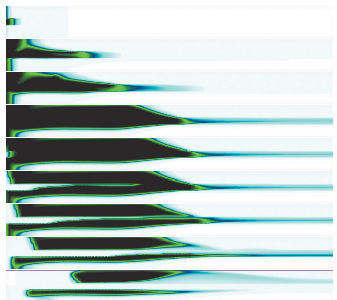
Рис. 5. Создание, разрыв и разрушение высоковязкой оторочки при импульсном режиме после начала закачки полимера. Поле концентрации ПАА на моменты: t=2.0, 2.08, 4.24, 2.80, 4.0, 4.08, 4.16, 4.80, 8.00 .
