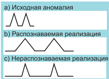
Рис. 2. Примеры идентифицируемой (b) и неидентифицируемой (c) особенности сигнала при использовании базового вейвлета, настроенного на участок вида (a).
