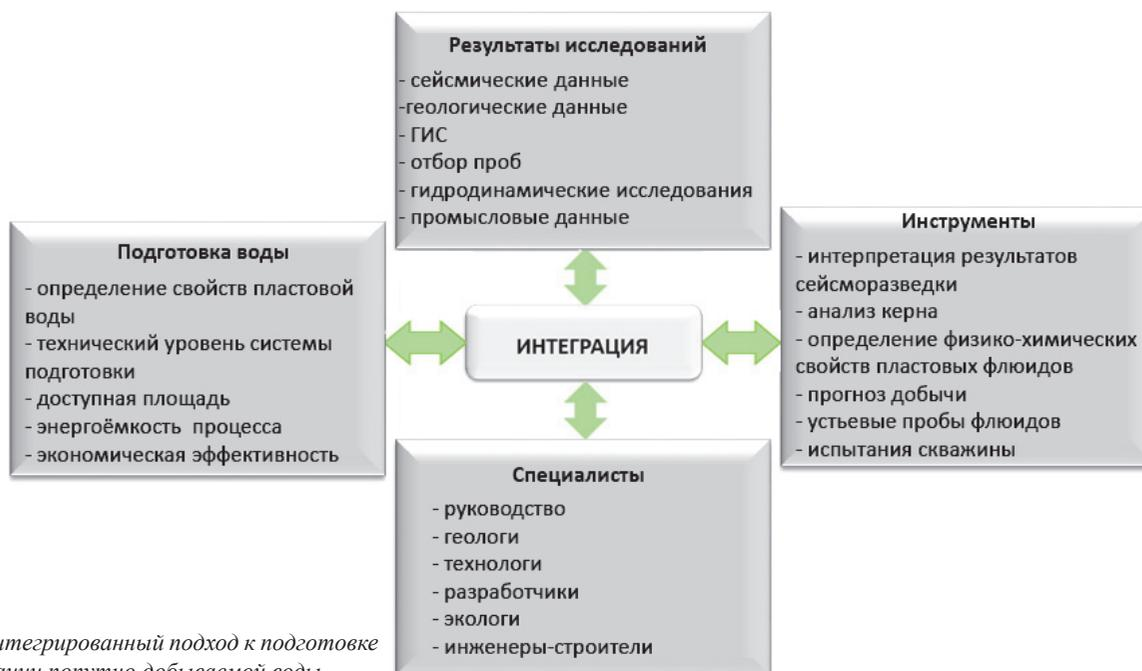
Рис. 1. Интегрированный подход к подготовке и утилизации попутно добываемой воды
