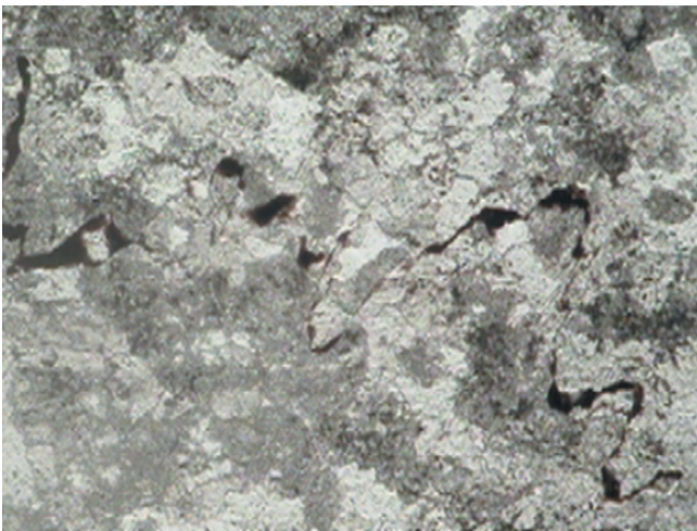
Рис. 6. Миннибаевская площадь, скв.3089, гл.1253м. Стилолитовый шов, декорированный битумоидами. Николи II, Ув. 80х.
