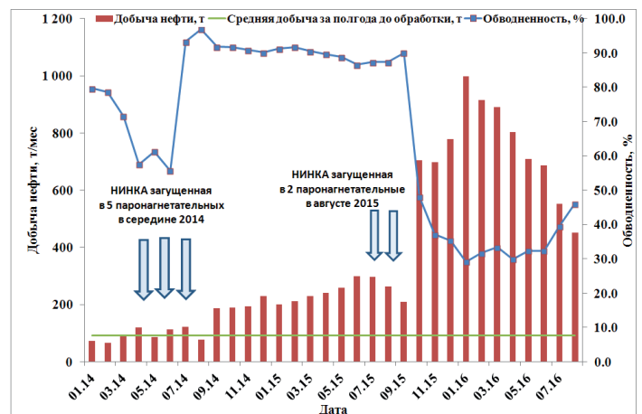
Рис. 13. Эффект обработки композицией НИНКА-3 в добывающей скважине 2949 на опытном участке ПТВ-Юго-Запад пермо-карбоневой залежи Усинского месторождения.
