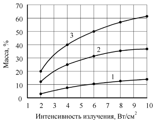
Рис. 2. Зависимость степени дезинтеграции песчано-глинистой составляющей минеральной гидросмеси от интенсивности кавитации, при времени воздействия (мин): 5(1); 10(2); 15(3)
