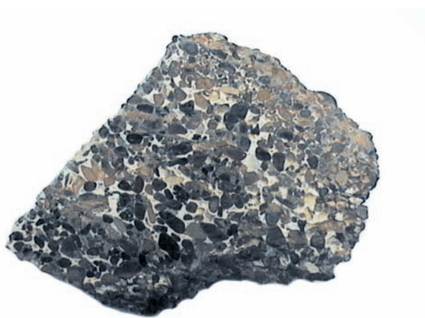
Рис. 3. Таш-Елгинское месторождение. Фрагмент конгломерата из терригенной толщи верхнеказанского подъяруса. Гальки скреплены первичным серозеленоватым карбонатно-глинистым цементом. Прожилковидные участки выполнены вторичным белым кальцитовым цементом кристаллизационного типа.
