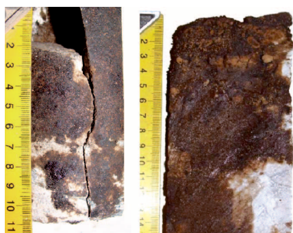
Рис. 1. Трещины тектонической разгрузки (слева). Сетка вертикальных и горизонтальных трещинок растворения, зона ВНК (справа) (Морозов и др., 2012).
