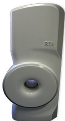
Рис. 1. Внешний вид сверхпроводящего магнита замкнутого цикла, предназначенного для лабораторного варианта прибора ЯМР «Керн».
