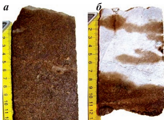
Рис. 1. Различные виды нефтенасыщенности керна. Тавельское месторождение. а) Равномерно нефтенасыщенный образец керна. Скв. 5035. Гл. 761,9 м. б) Неравномерно нефтенасыщенный образец керна. Преобладают плотные участки (белое). Скв. 5035. Гл. 762,9 м.
