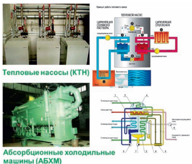
Рис. 8. Элементы и схема использования тепловых насосов. Назначение: 1. экономия тепловых ресурсов за счет использования низкопотенциальных источников энергии; 2. охлаждение товарной нефти с одновременной экономией тепловой энергии (топливного газа).
