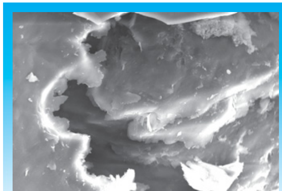
Рис. 6. Коррозия порообразующих минералов. Формирование коррозионной пористости. Скв.20009, Ново-Елховская, обр.1425, инт.4388,2-4391,7м. Ув.950х.
