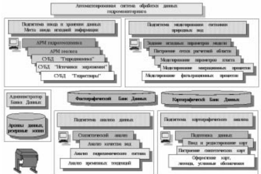
Рис. Автоматизированная система обработки данных гидромониторинга.
