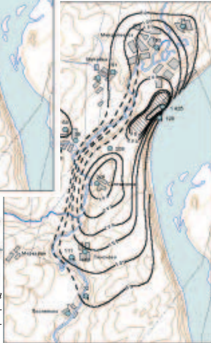
Рис. 1. Гидрохимическая схема природных вод нефтепромысла «Майский» по данным многолетних наблюдений.
