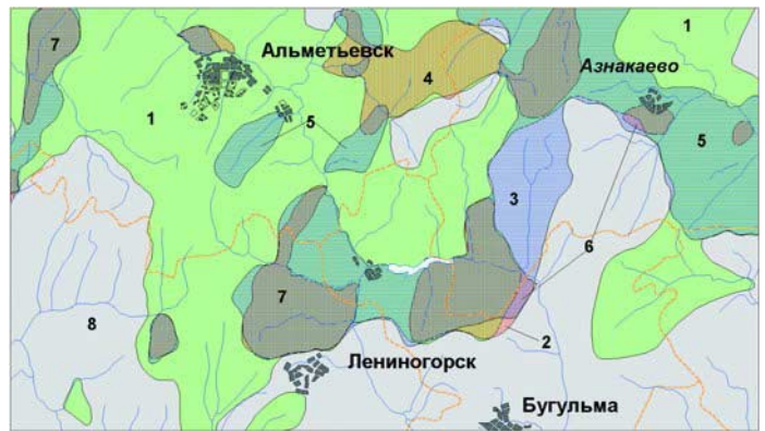
Рис. 1. Распространение подземных вод нижнекамской водоносной свиты, не соответствующих требованию СанПиНа (фрагмент): 1 - по общей жесткости; 2 - по хлоридам; 3 - по минерализации; 4 - по жесткости и хлоридам; 5 - по жесткости и минерализации; 6 - по хлоридам и минерализации; 7 - по хлоридам, жесткости и минерализации; 8 - отвечающие требованиям.
